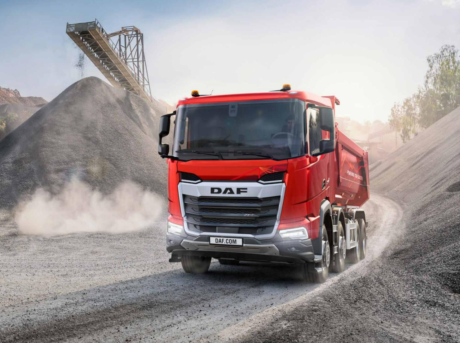
Il paraurti in acciaio in 3 pezzi e la piastra di protezione del radiatore sono estremamente resistenti, per ridurre il rischio di danneggiare le parti più vulnerabili situate nella parte anteriore del veicolo. Il paraurti dispone inoltre di quattro luci a LED di serie: due abbaglianti e due fendinebbia.
