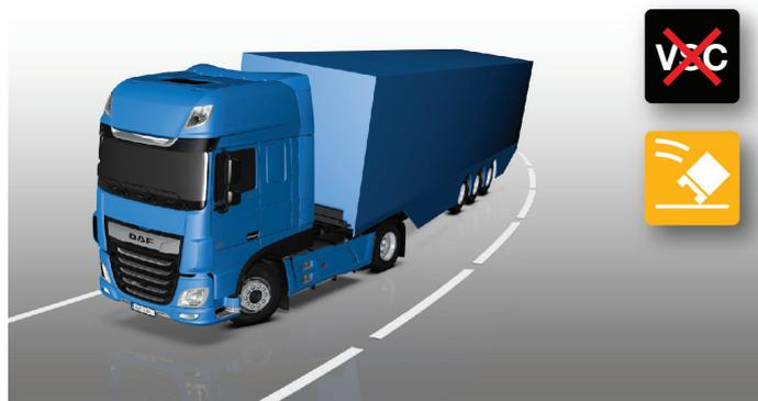
In caso di sottosterzo, la parte anteriore del veicolo si sposta verso il bordo esterno della curva e, se l'azione non viene eseguita una manovra correttiva, il veicolo esce di strada. Il VSC aziona i freni sulle ruote interne rispetto alla curva per riportare il trattore sul percorso iniziale.
