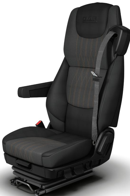
I veicoli LF DAF sono realizzati per la distribuzione urbana e regionale. Il conducente ha l'esigenza di guidare in zone trafficate e di scendere e salire più volte, pertanto particolare cura viene riservata alla sicurezza, alla resistenza e all'ergonomia del sedile. I dispositivi di sicurezza, quali i poggiatesta integrati e le cinture di sicurezza a 3 punti, non soltanto rispondono ai requisiti di legge, ma assicurano anche un ottimo livello di comfort e comodità.
