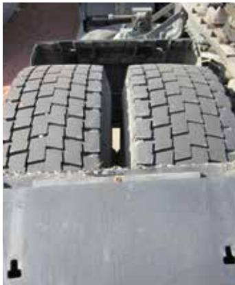
Normale usura del pneumatico con uno spessore minimo del battistrada di 8 millimetri su tutte le ruote.
